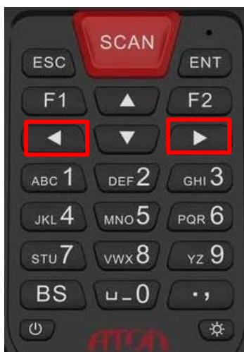
Рисунок 15. Клавиатура устройства (навигационные клавиши выделены красной рамкой)
